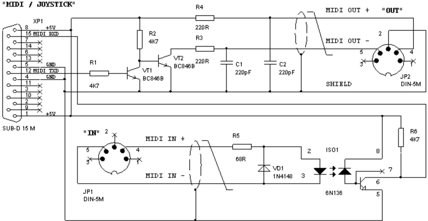
При самостоятельном повторении схемы возможна замена транзисторов VT1, VT2 практически на любые маломощные n-p-n, например, КТ3102, КТ315, 2SC9014, 2N2222 и др. Диод VD1 можно заменить на КД521 или КД522.
